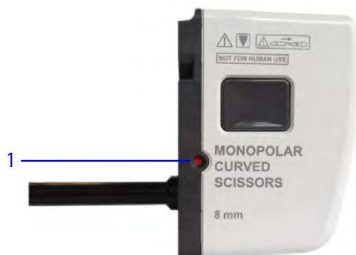
Figura 9.50 Indicador do número máximo de utilizações em um instrumento expirado
