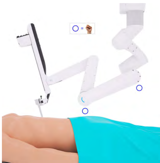
Figura 9.25 Ajuste do afastamento do paciente com o espaço de um punho
