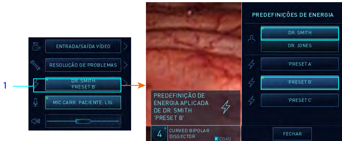
Figura 10.44 Seleção de predefinições na tela sensível ao toque, exemplo em console duplo
