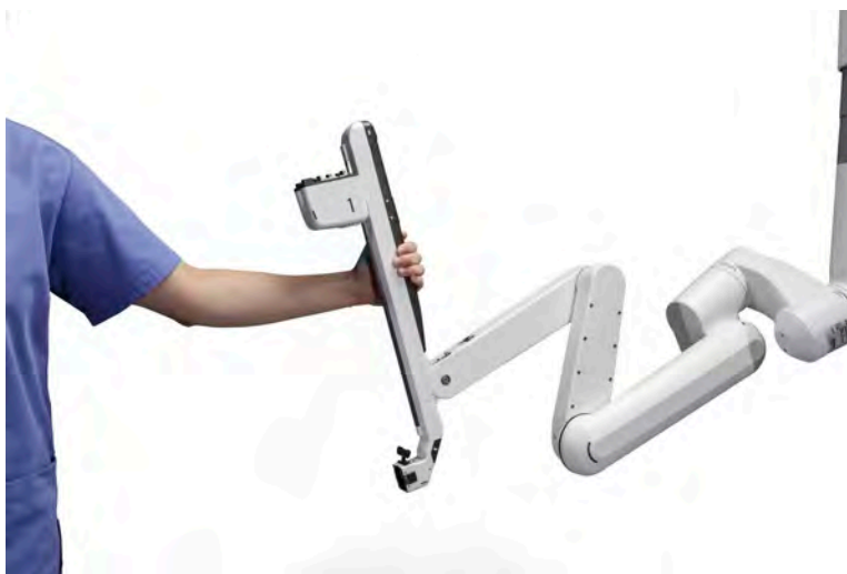
Figura 9.27 Segure o braço pela alça cinza e mova conforme desejado.
