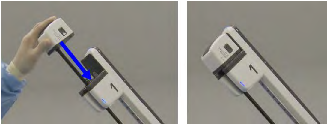
Figura 9.39 Introdução do instrumento dentro da cânula e do adaptador esterilizado
