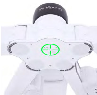
Figura 6.24 Fixe todos os 4 adaptadores esterilizados do instrumento e o laser de posicionamento acenderá
