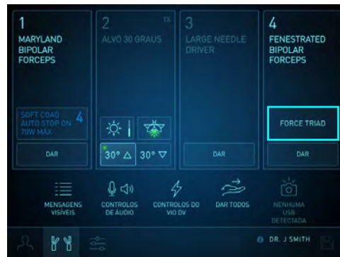
Figura 10.46 VIO dV e ForceTriad conectados - dois instrumentos bipolares, exemplo
