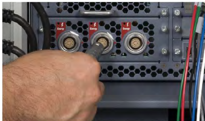
Figura 4.11 Tomadas de energia (painel traseiro do Carrinho de Visão)
