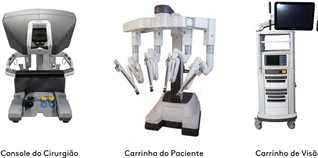
Figura 2.1 Principais componentes do sistema
