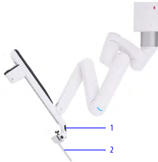
Figura 9.34 Exemplo de onde apoiar o braço para ajustar a articulação flexível
