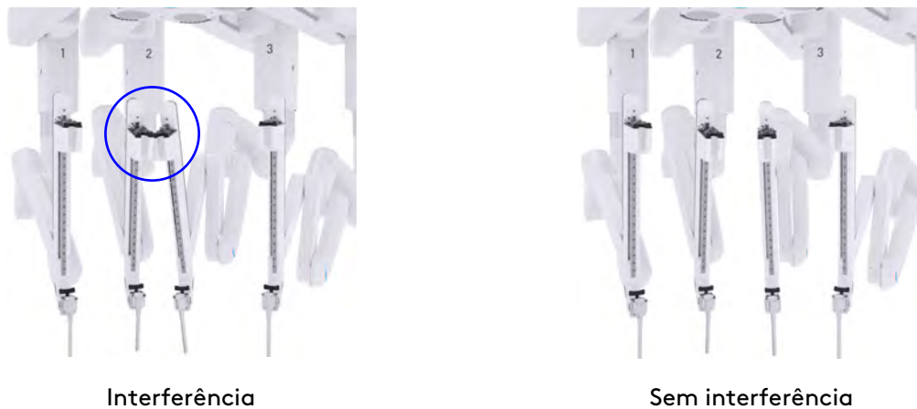
Figura 9.42 Ajuste da articulação flexível para resolver a interferência
