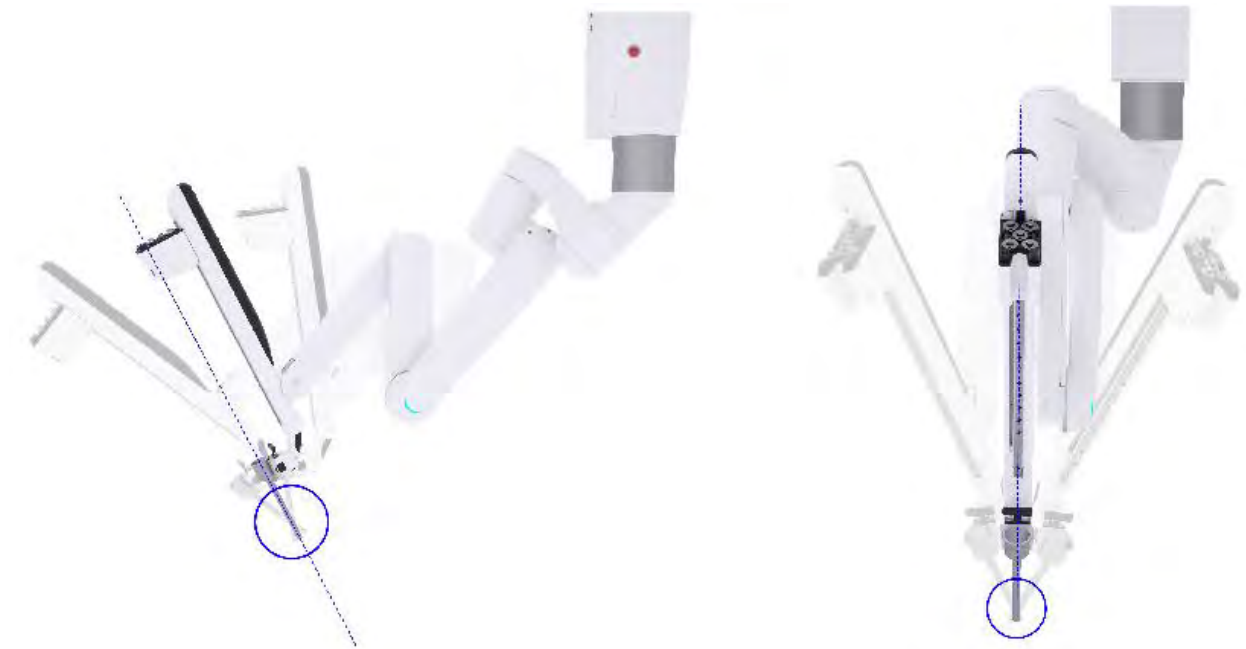
Figura 9.29 Exemplos de movimento da embreagem do instrumento
