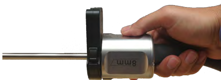
Figura 7.12 Endoscópio na orientação para cima
