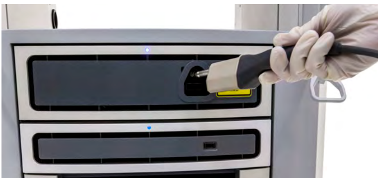
Figura 7.7 Conecte o conector ao Controlador do Endoscópio
