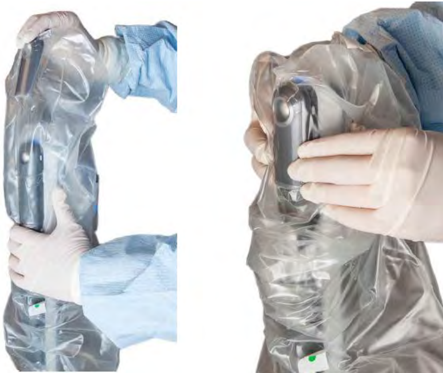
Figura 6.21 Fixe o grampo do braço
