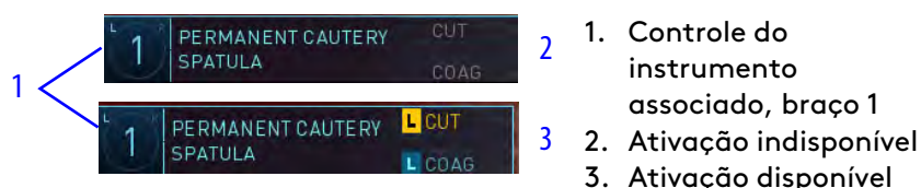
Figura 10.49 Controle do instrumento e da ativação
