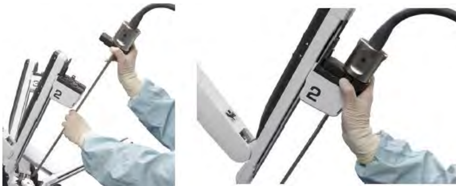
Figura 7.16 Introdução do endoscópio dentro da cânula e do adaptador esterilizado
