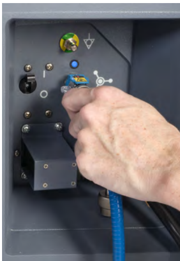
Figura 4.6 Levante a tomada e conecte o cabo
