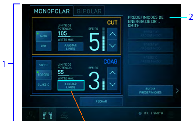
Figura 10.39 Ajuste de configurações de limite de potência no painel de toque, exemplo
