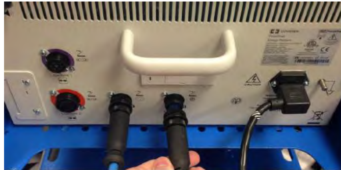
Figura 4.10 Conexão da unidade eletrocirúrgica
